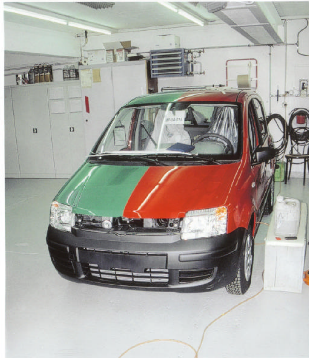
Mehrfarbigkeit ist möglich. Die Folien sind so hauchdünn, dass beim Farbübergang von blossen Auge kaum sichtbare Kanten entstehen.
