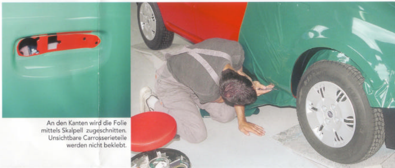
Bei Wölbungen und Kanten wird die Folie mit dem Fön erwärmt, um Verfärbungen (helle Stellen) durch zu starke Dehnung zu vermeiden.
