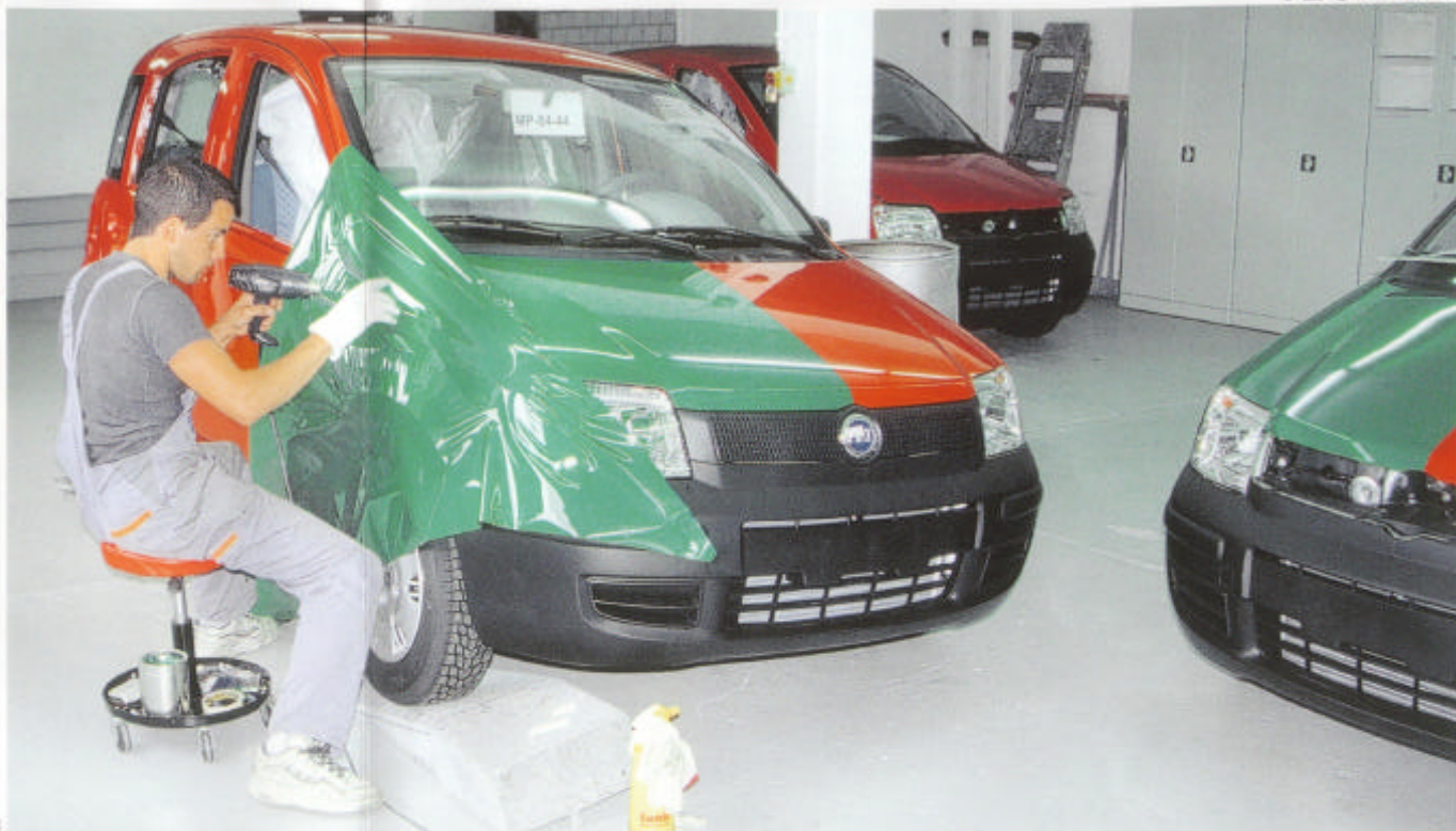
Bei Wölbungen und Kanten wird die Folie mit dem Fön erwärmt, um Verfärbungen (helle Stellen) durch zu starke Dehnung zu vermeiden.
